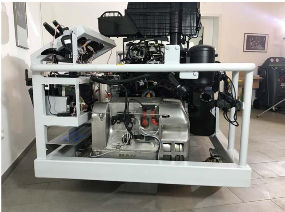
Komplett funktionsfähiger Mercedes LKW Motor mit PLD und SCR (Bluetec System) Euro 4/5. Der Motor hat ein Pumpe Leitung Düse Einspritzsystem mit Abgasnachbehandlung über AD Blue System.
