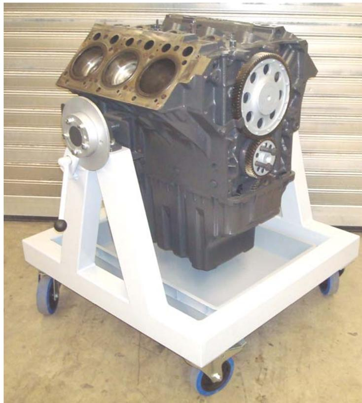
Die gebrauchten Motoren sind innerlich und äußerlich gereinigt sowie neu lackiert.
