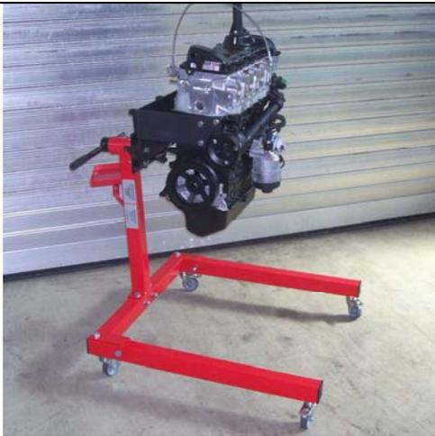
VW 2,8I VR 6 Motor –Steuerung über Kette mit 4-Ventil Technik.
