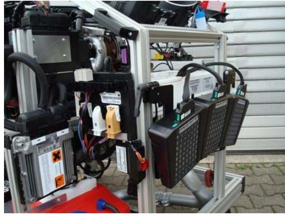
Breakout-Box System fest am Motor installiert –klappbar.
