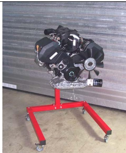
VW V6 2,8 I MPI Zahnriemengesteuert inkl. Schaltsaugrohr und Anbauteile wie Einspritzventile Sensoren/Aktoren
