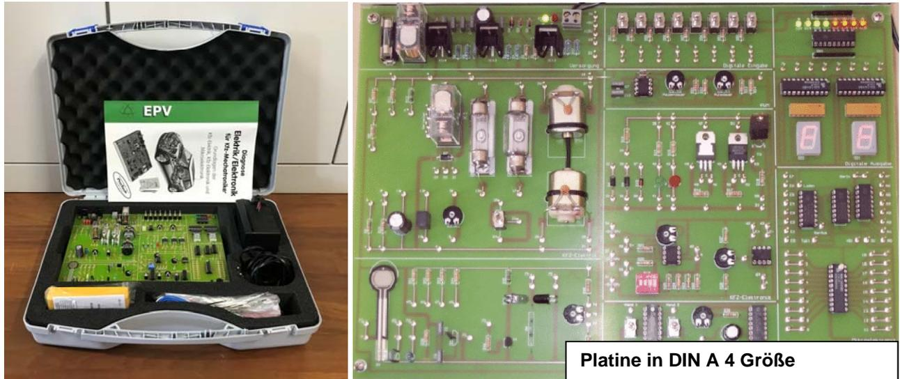
Der KFZ-Diagnosekoffer besteht aus Hardware und Teachware. Er vermittelt dem Lernenden die Funktion und Arbeitsweise elektrischer und elektronischer Komponenten und lehrt an einfachen Beispielen das elektrische Messen und Erkennen von Fehlern.
