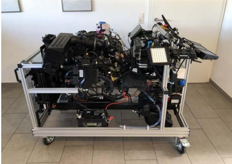
Motor mit voll funktionsfähiger Klimaanlage -2 Zonen Climatronic am Beispiel 2,0TDI mit SCR VW Caddy
