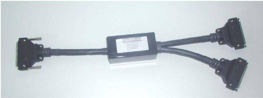
Mit diesem Y –Stück können an einem Fahrzeugadapterkabel mehrere Breakout- Boxen angeschlossen werden. Somit kann an einem Motor oder Fahrzeug mit mehrern Schülern gemessen werden.
