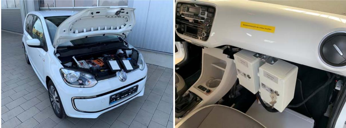
Das Funktionsmodell VW e-Up! dient als Schulungsfahrzeug Elektro sowie Hochvolt. Dafür wurden folgende Umbauten/Zubehör verbaut:
