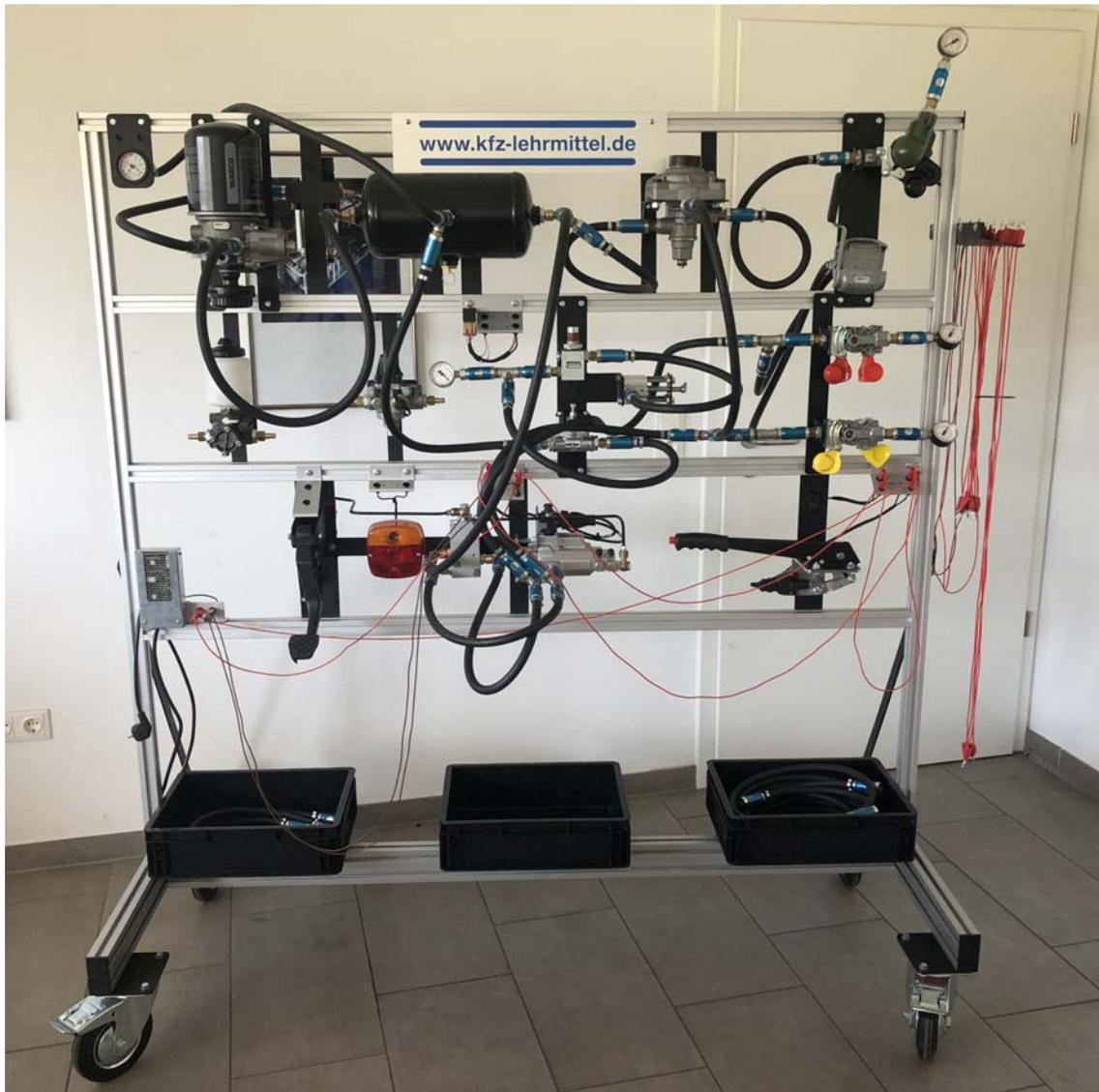
Die Druckluftanlage besteht aus original Bauteilen wie sie auch in einer Lof Zugmaschine verbaut werden. Auf der Wand sind folgende Druckluftsysteme vorhanden:
