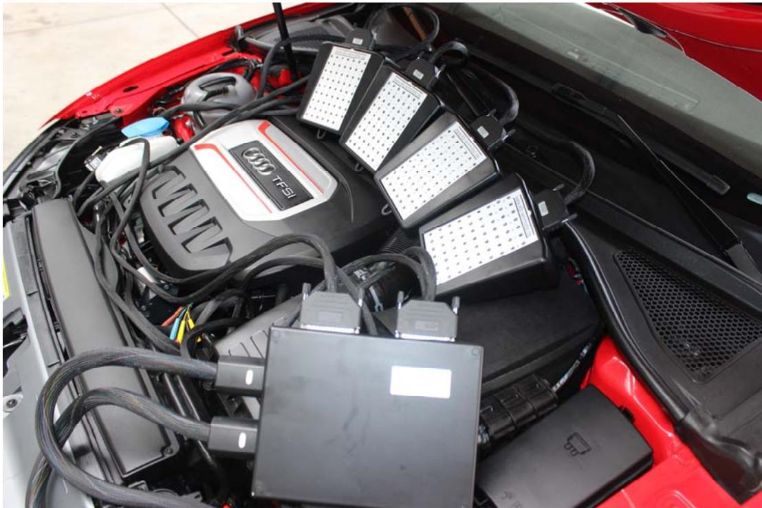
Breakout-Box-System (196 PINs) in einem Audi A3 TFSI Motor. Set besteht aus vier Breakout-Boxen 62 PIN (Best. Nr. 02-100) sowie vier Adapterkabel (Best. Nr. 02-115) und Adapterkabel VW 196 PIN (Best. Nr. 02-345)
