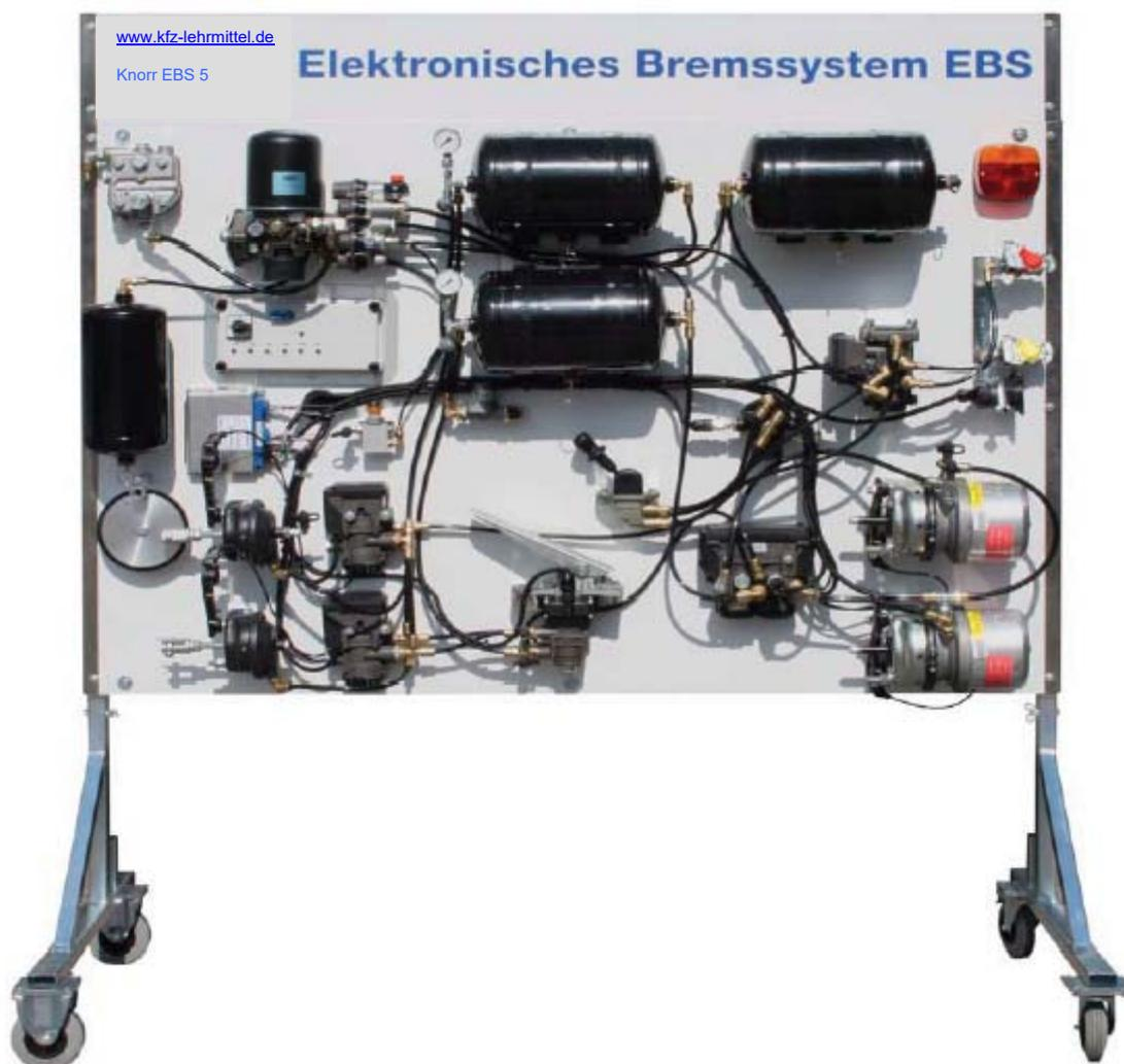
Dieses Trainingsmodell stellt ein vollwertig, funktionsfähiges Motorwagen Bremssystem mit EBS und redundanter Druckluftbremse dar.
