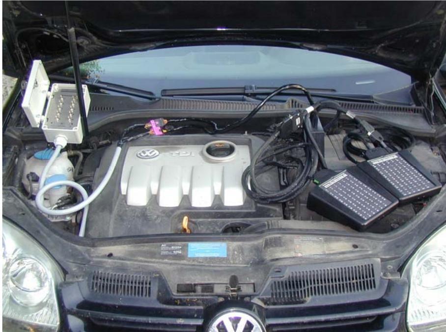
**Fehlerschaltung in Y Kabel 121 PIN (Motorsteuerung) eingebaut.**
