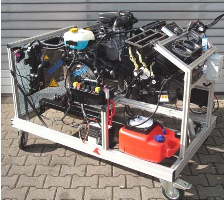
Benzinmotor mit voll funktionsfähiger Klimaanlage - Climatronic am Beispiel 1,6l Opel Z16XEP Twinport
