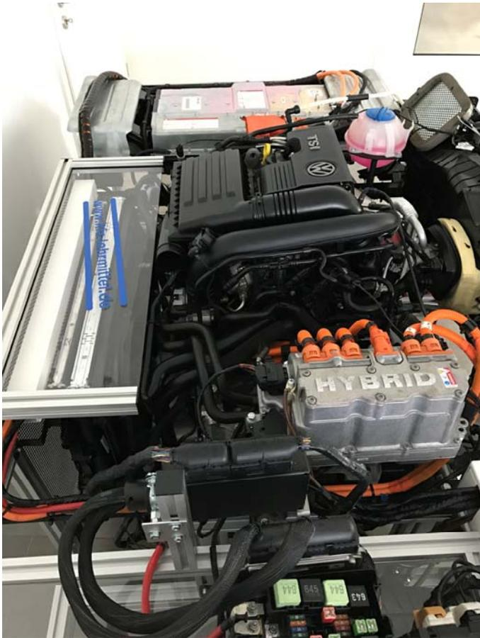
Am Modell ist ein Original Kabelstrang verbaut, sowie Original Sicherungs- und Relaiskasten. Auch sind sämtliche Original Steuergeräte wie Diagnoseinterface, Motor-, Getriebe-, Schaltafeleinsatz, Klima-, Lenkung-, Bordnetz-, Batterie-regelung, Hybrid Batteriemangement und Radio mit Display Energiemangement verbaut. Dadurch ist die Verwendung von Original Schaltplänen möglich. Auch die Diagnose der Steuergeräte ist voll funktionsfähig.
