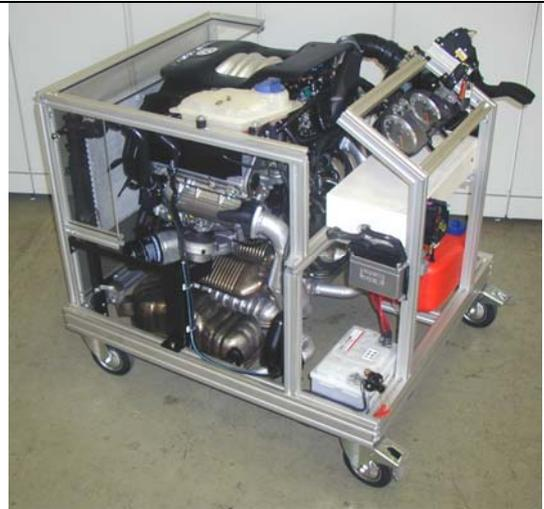
VW V6 2,8 MPI mit kompletter 2 Rohr
