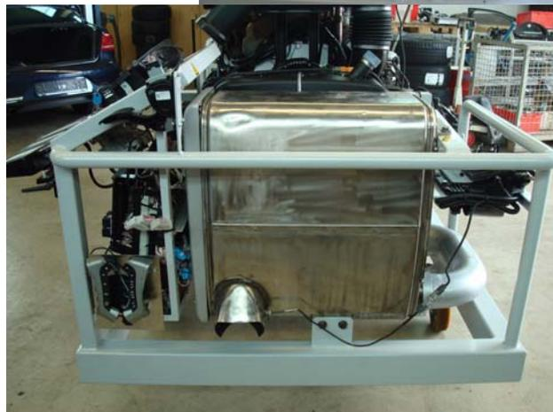
Breakout Box, Fehlerschaltung und Abgasnachbehandlung mit SCR System –Additiv Einspritzung und Rußfilter
