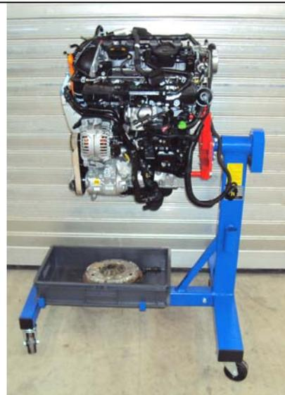
TFSI Motor mit Sensoren und Aktoren mit Ölwanne – Gestell mit Schneckengetriebe
