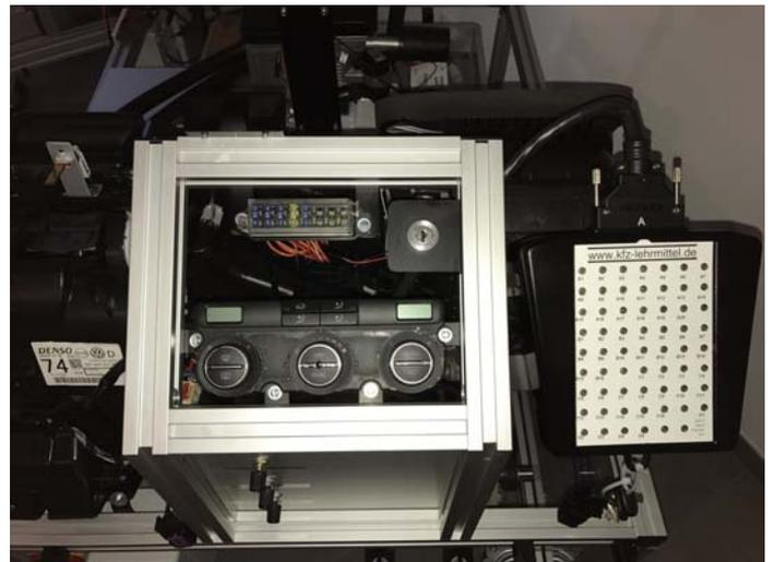
Option Breakout Box Klimasteuergerät
