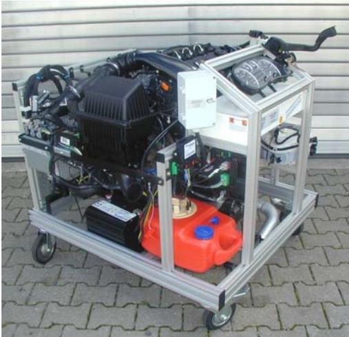
Peugeot 2,0 HDI mit Siemens Common Rail und Piezoinjektoren
