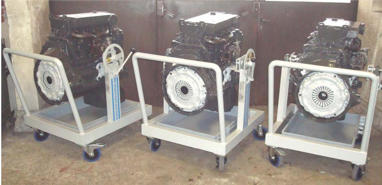
Der LKW Motor Mercedes / MAN ist auf einem drehbaren Gestell montiert. Es ist eine Drehung um 360° möglich. Der Motor kann in jeder beliebigen Stellung festgeklemmt werden. Da der Motor am Kurbelgehäuse drehbar gelagert ist, kann er komplett im Gestell zerlegt werden. Weiterhin ist eine Montageübung der Kupplung über einen Zentrierdorn möglich.
