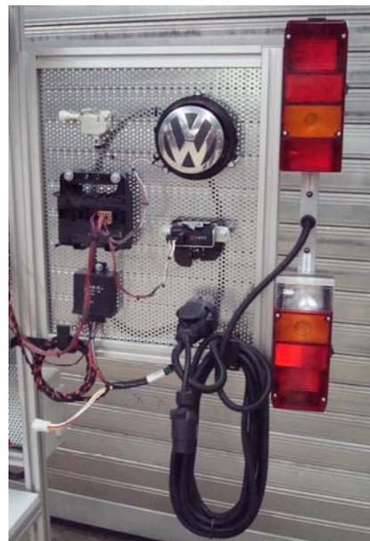
03-346 Anhängerleiste – Lichtleiste zur Simulation eines Anhängers (Blinkerausfallkontrolle am Anhänger kann simuliert werden sowie Dauerstrom und Ladeleitung mit 13 Pol und 7 Pol)
