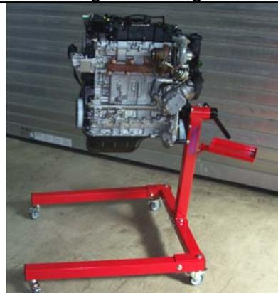
Ford 1,6 TDCI Common-Rail Motor mit Injektoren, Hochdruckpumpe, Turbolader und am Motor angebrachte Sensoren wie Drehzahlgeber, Hallgeber usw.
