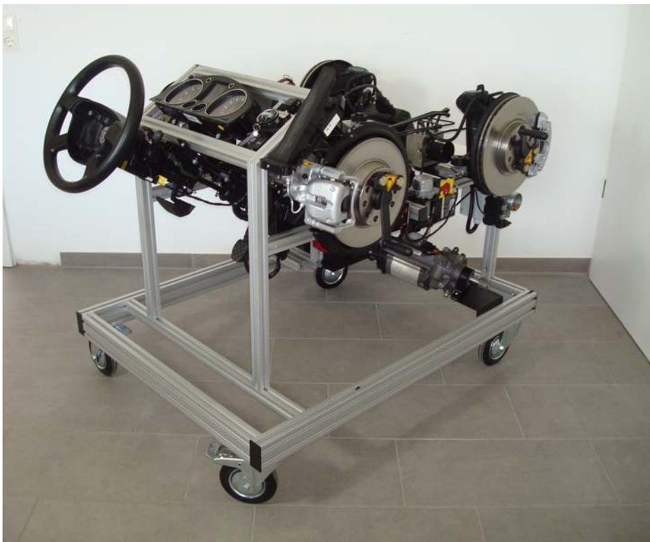
**Das Modell besteht aus allen Originalbauteilen eines Bremssystems Golf bzw. Golf 5/6 mit ABS / ESP wahlweise Golf IV bzw Passat mit EMF.**
