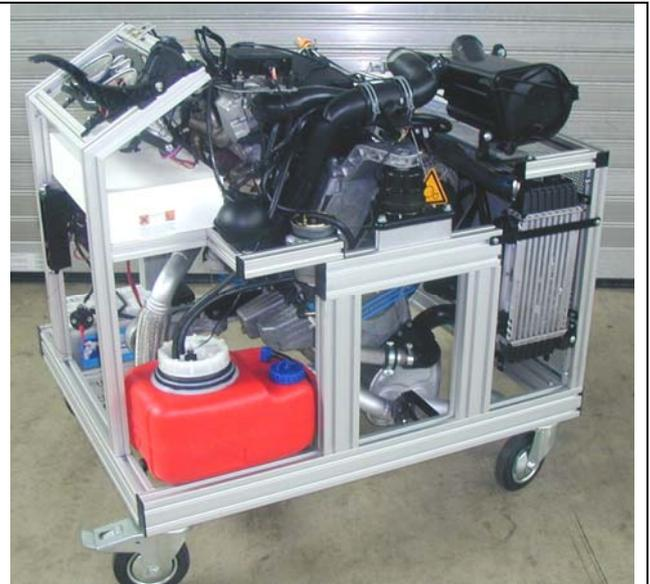
1,4l Pumpe-Düse mit Ladeluftkühler
