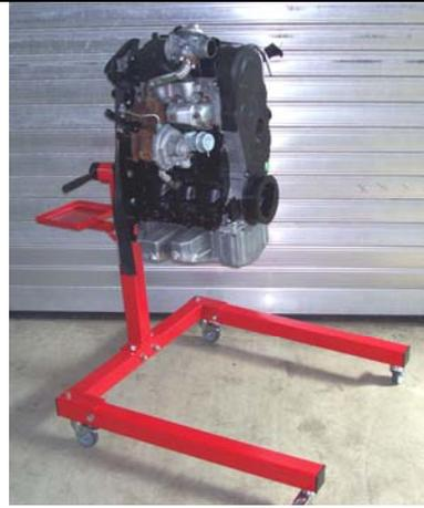
VW 1,4I 3-Zylinder Pumpe Düse Motor mit Pumpe-Düse Einheiten, Turbolader und am Motor angebrachte Sensoren wie Drehzahlgeber, Hallgeber usw.
