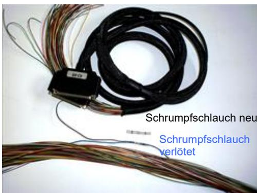
Zum Einlöten der Kabel bieten wir spezielle klarsichtige Schrumpfschläuche an. Dieser Schrumpfschlauch hat in der Mitte einen Lötring und außen zwei Klebedichtringe.
