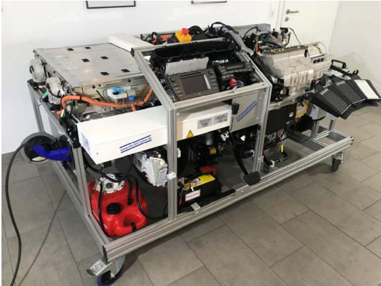
Voll funktionsfähiger Aufbau eines Toyota Prius Plug in Hybrid
