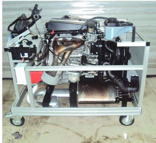
Abbildung zeigt ein M271 C180 Kompressor mit Ladeluftkühlung und Saugrohreinspritzung Siemens
