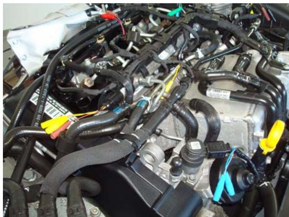
Einbau von Messbuchsen, an Sensoren und Aktoren in denen Fehler aufgeschaltet sind, möglich.
