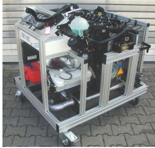
Peugeot HDI mit FAP System Partikelfilter mit Additivtank
