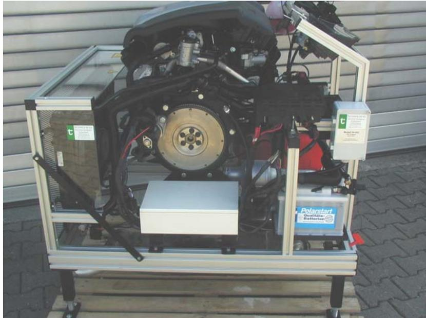
Sonderaufbau zum Anschluss an einen Leistungsprüfstand
