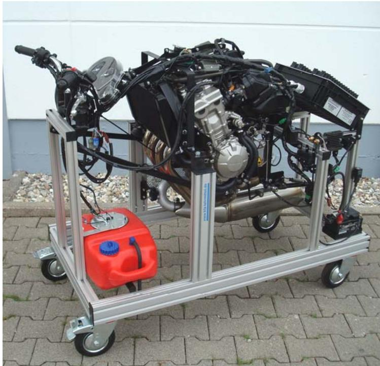
Honda Motor mit Getriebe und elektronischer Einspritzung PGM-FI voll funktionsfähig aufgebaut mit Messbox und Fehlerschaltung. Im Lieferumfang sind die Original Honda Unterlagen enthalten.
