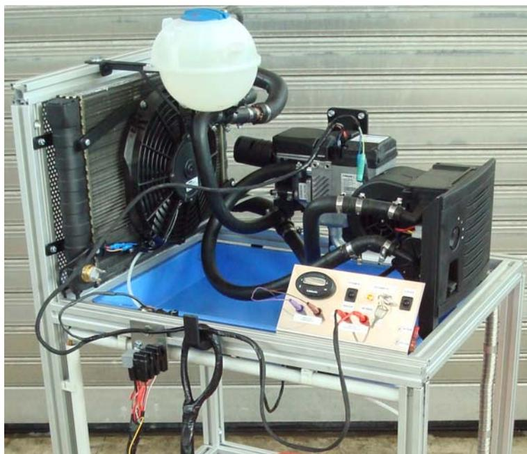
Schulungsmodell Standheizung – Dauerbetrieb komplett aufgebaut und in Betrieb.
