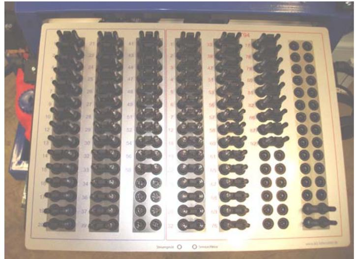
Buchsenkasten in 4mm Technik mit Steckbrücken fest installiert. Jeder PIN des Motorsteuergerätes ist über eine Messbrücke verfügbar. Sensoren/Aktoren können ohne Abzug des Motorsteuergerätes gemessen werden.
