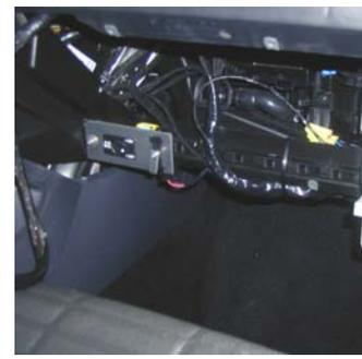
Y-Kabel im Komfortsteuergerät
