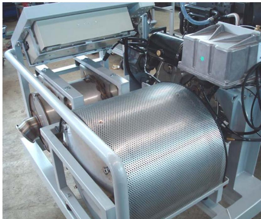
Abgasnachbehandlung mit SCR System –Additiv Einspritzung und passivem Rußfilter
