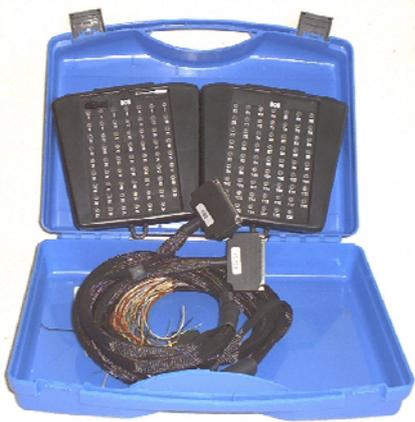
2x62PIN Universalkabel (02-400) mit 2x62PIN Breakout-Box (02-100)
