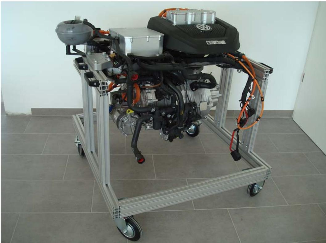
VW E Golf Antriebseinheit auf einem Gestell aus Aluprofil aufgebaut.
