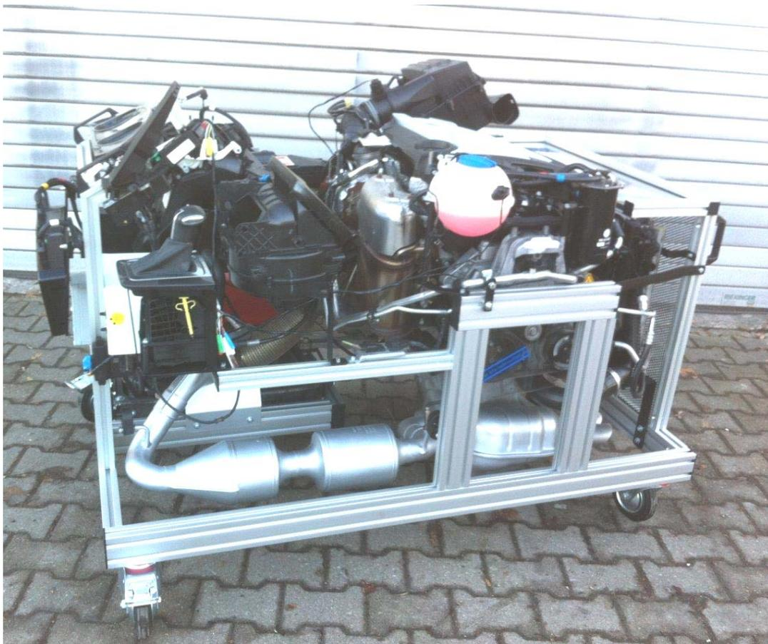
VW CDI SCR Euro 6 mit Klima und DSG Getriebe – funktionsfähig
