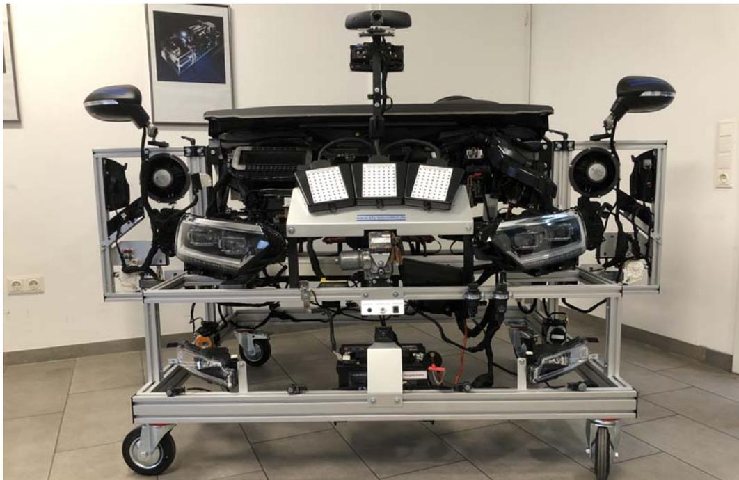
Abbildungen zeigen Modell mit LED Scheinwerfer, Totwinkelassistent, Umfeldkamera
