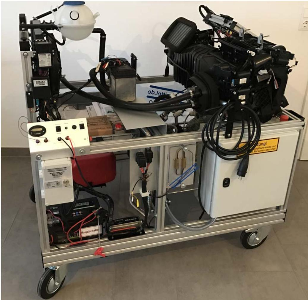
Das Modell Climatronic bauen wir auch in Verbindung mit unserem Standheizungsmodell auf. Dadurch ist sowohl die Temperaturregelung warm / kalt als auch eine Nachrüstung einer Standheizung darstellbar.
