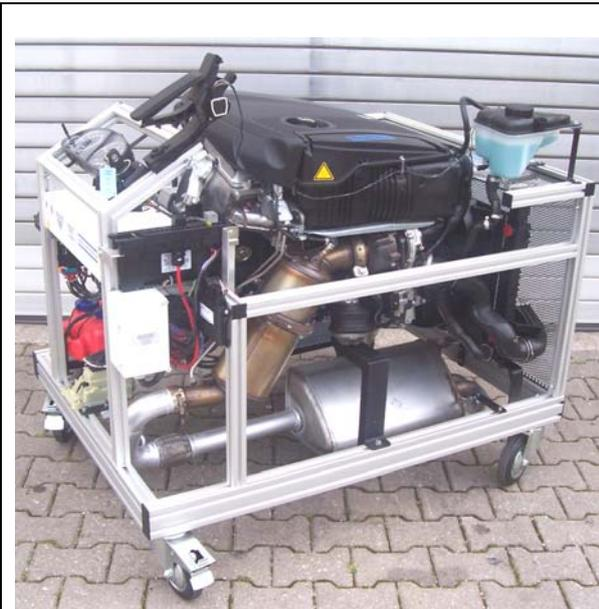
Die Abbildung zeigt einen C/E 220 CDI Motor OM 646 mit Original Partikelfilter/Lambda-Sonde Druck und Temperatur Sensor
