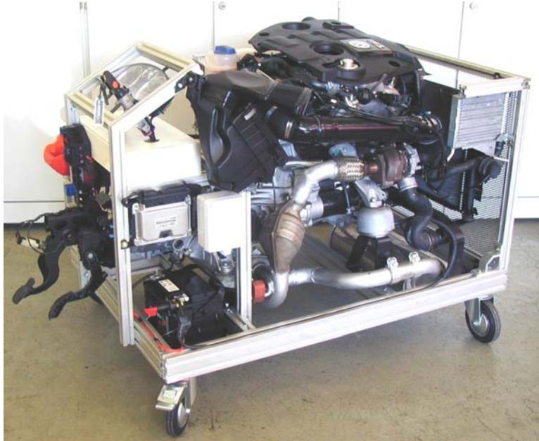
VW 1,9 Pumpe Düse D4 mit Fehlerschaltung
