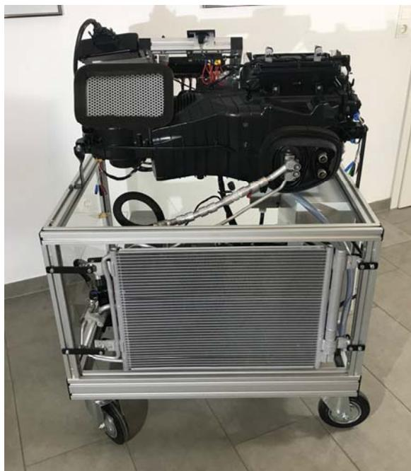
**Rückansicht mit Kondensator, Trockner Füllanschlüssen**
