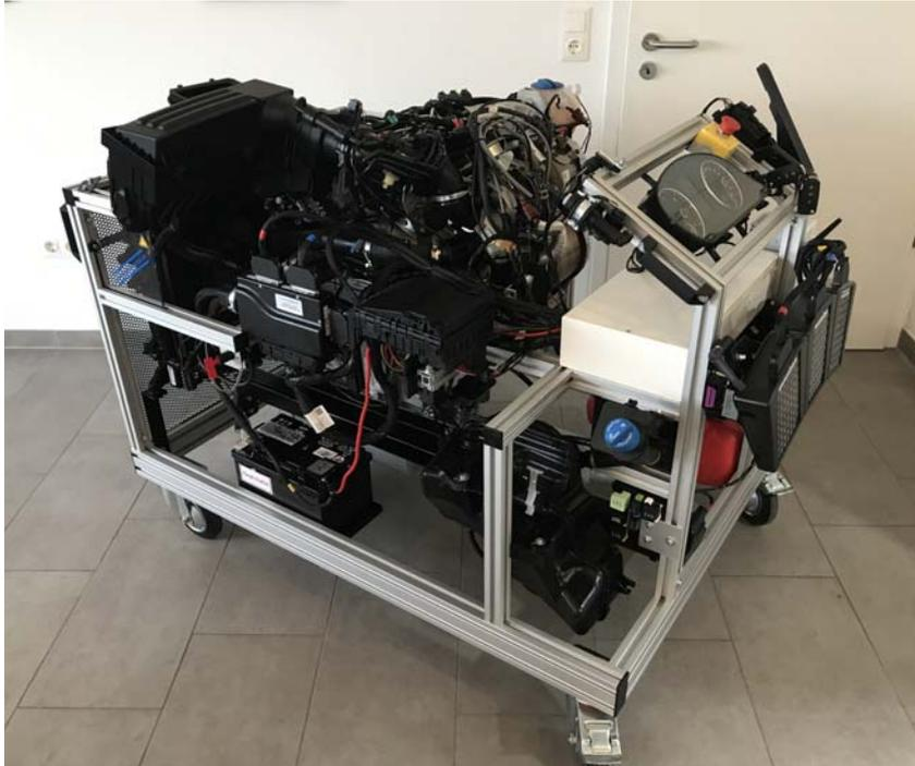
**VW TDI Motor 2,0l mit SCR Katalysator**
