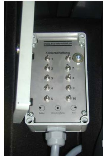
Fehlerschaltung abschließbar im Fahrzeug eingebaut
