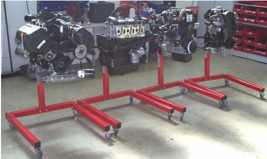
Wir liefern Ihnen kostengünstige moderne Motoren (gebraucht mit geringer Laufleistung) auf einem fahrbaren Gestell aufgebaut mit 4 Lenkrollen und Radfeststellung. Alle Motoren aus neuester Fertigungsgeneration. Die Motoren sind sowohl für Zahnriemeneinstellung, Steuerzeiteneinstellung, Hochdruckpumpenmontage, Zylinderkopfmontage, Einstellung von Pumpe-Düse Elementen usw. geeignet. Am Gestell befindet sich eine Ablage für Schrauben.
