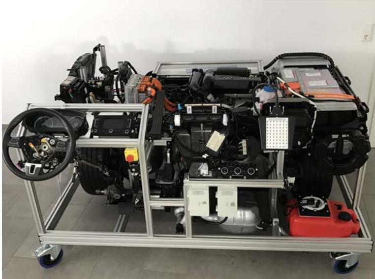
Voll funktionsfähiger Aufbau eines Jetta Hybrid
