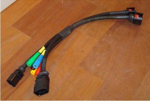
6 polige Y Kabel Sensoren Aktoren
