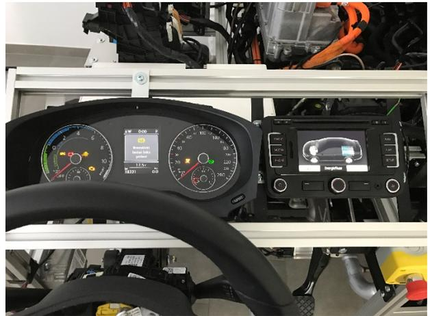
Am Modell ist ein Original Kabelstrang verbaut, sowie Original Sicherungs- und Relaiskasten. Auch sind sämtliche Original Steuergeräte wie Diagnoseinterface, Motor-, Getriebe-, Schaltafeleinsatz, Klima-, Lenkung-, Bordnetz-, Batterie-regelung, Hybrid Batteriemangement und Radio mit Display Energiemanagement verbaut. Dadurch ist die Verwendung von Original Schaltplänen möglich. Auch die Diagnose der Steuergeräte ist voll funktionsfähig.
