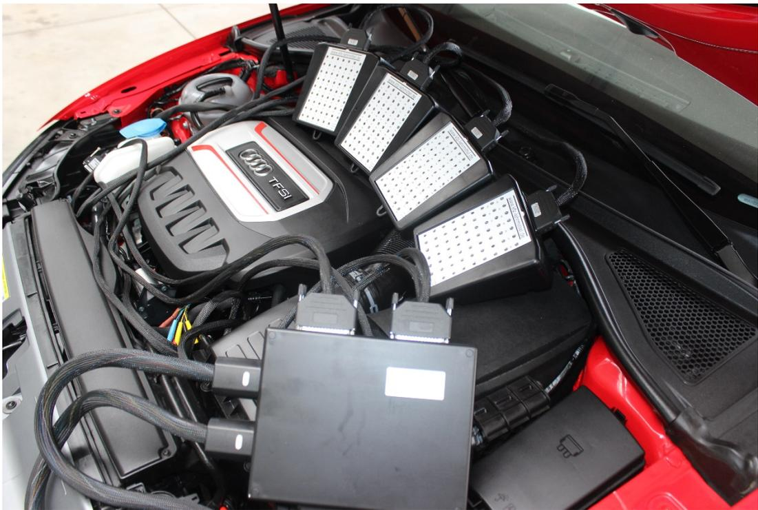
Breakout-Box-System (196 PINs) in einem Audi A3 TFSI Motor. Das Set besteht aus vier Breakout-Boxen mit jeweils 62 PINs (Best. Nr. 02-100) sowie vier Verbindungskabel Best. Nr. 02-115) und Adapterkabel VW 196 PIN (Best. Nr. 02-345),
