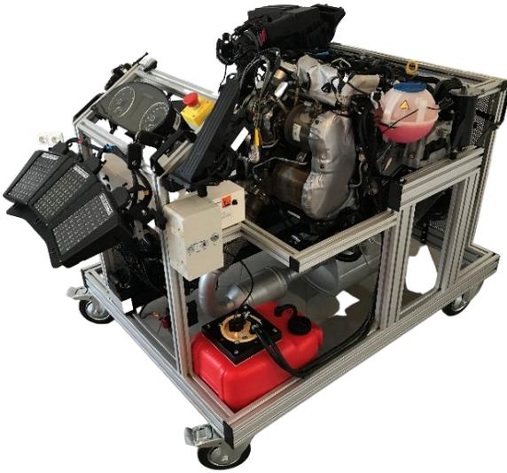
**VW TDI Motor 2,0l mit SCR Kat**
