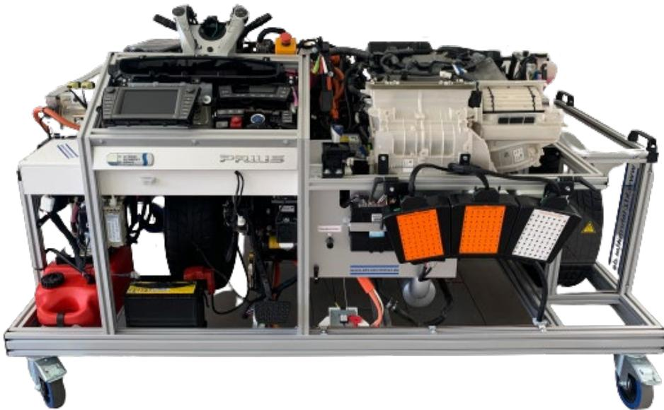
Voll funktionsfähiger Aufbau eines Toyota Prius Plug in Hybrid
